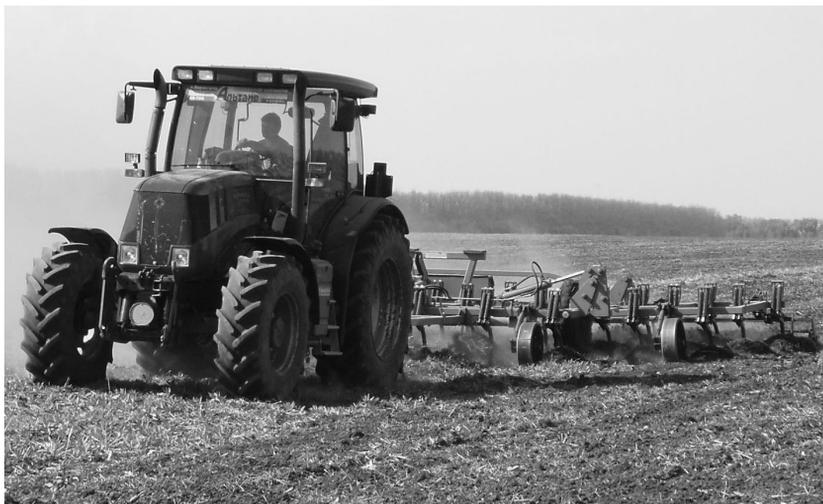
*Рис. 4. Культиватор КППУ-8 в работе*
